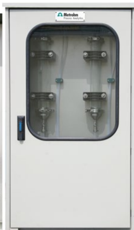
シェルター内に設置した実際の 専用サンプル前処理システム例
