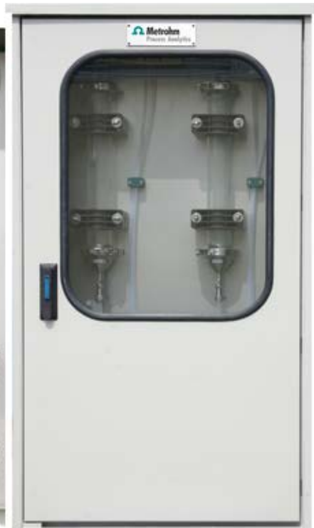
現場に設置されたシェルター付きサンプル前処理システムの実例
