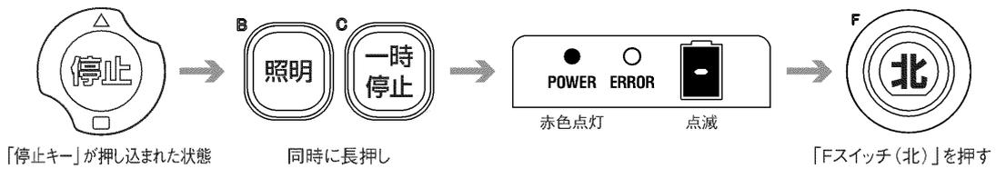
**状態確認** 現在の「誤り訂正/互換モード」の状態が表示されます
