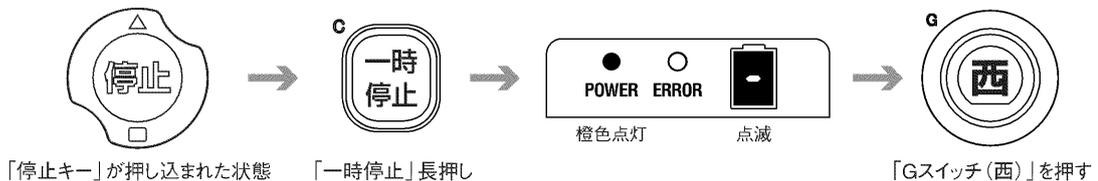
**状態確認** 現在の「傾斜検出機能」の状態が表示されます
