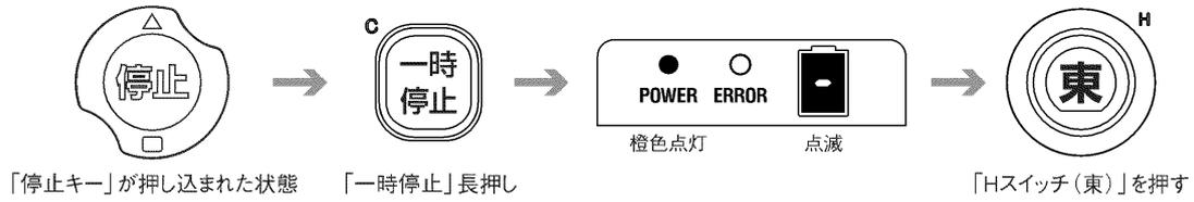
**状態確認** 現在の「落下衝撃検出機能」の状態が表示されます
