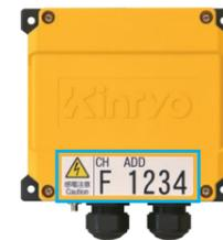
受信装置が制御器に書いてある「CH」、「ADD」の設定をロータリースイッチで合わせるだけで簡単に設定できます。
